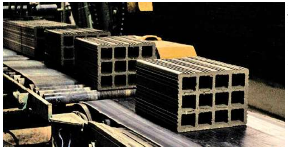
Aproveitamento da sobra do arroz nos tijolos reduz extração de argila e acelera secagem do produto
